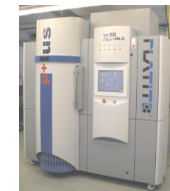
Beschichtungsanlage  $\pi^{300} + \text{DLC}$
