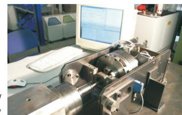
Dynamische Werkzeug- und Spannhalterprüfung
