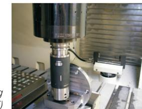
Sensorintegriertes Ausbohrwerkzeug auf einem BAZ (GFE)
