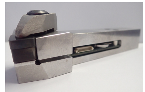
Bild 3: Drehwerkzeughalter mit integrierter Elektronik (Versuchsmuster GFE)
