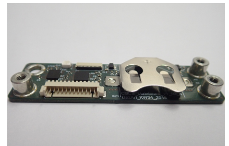
Bild 2: Auswerteelektronik mit MSP830 und Batteriefach
