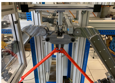
Bild 1: Aufbau des Demonstrators: Bolzenschneiderprüfsystem
