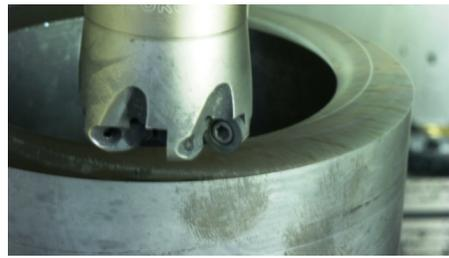
Bild 2: Test der hartstoffbeschichteten Werkzeuge im GFE Versuchsfeld
