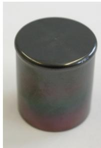
Bild 3: Beschichteter Fließpresskopf (DLC-Beschichtung CROMVlc2) sowie Anzahl der mit den beschichteten Werkzeugen gefertigter Teile
