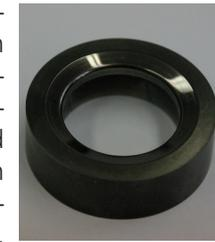
Bild 2: Beschichteter Ziehring (DLC-Beschichtung nACVlc) sowie Anzahl der mit den beschichteten Werkzeugen gefertigten Teile
