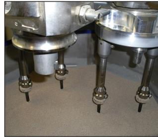
*Erarbeitung geeigneter Schneidkantenpräparations-technologien*
