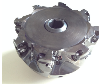
Bild 3: Versuchsmuster eines HD-Fräasers mit variabler Kühlmittelzufuhr
