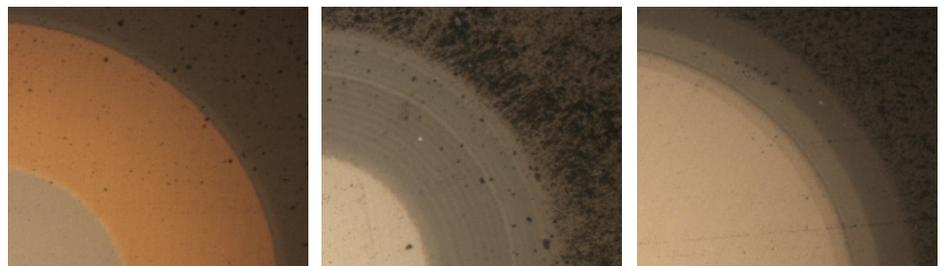
Bild 2: Auswahl abgeschiedener und getesteter Schichtsysteme: sauerstoffhaltige Schichtsysteme; kohlenstoffbasierte Gradienten-Schicht; Nanocomposite-Triple-Schichtsysteme (v.l.n.r.)
