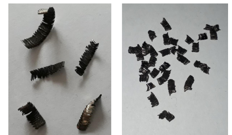
Bild 3: Spanbildung bei der Bearbeitung mit Keramikschnidplatten ohne Spanleitstufe (li.) und mit Spanleitstufe (re.)
