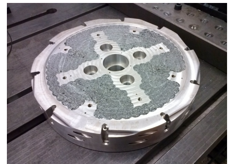
Bild 3: Werkzeugprototyp in hybrider Leichtbauausführung
