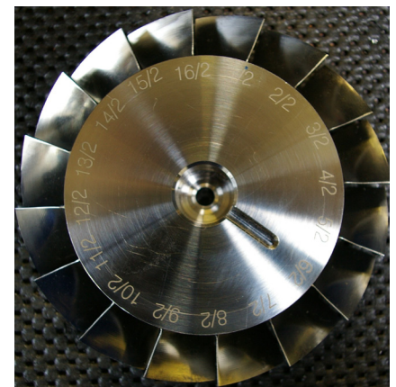
Bild 3: Beispiel für durch Fräsen hergestelltes Einsatzbauteil aus Nickelbasiswerkstoffen
