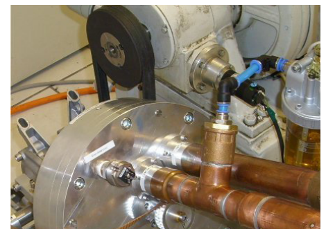
Bild 2: Realisierte Variante 2 des Membranmotors auf dem Prüfstand
