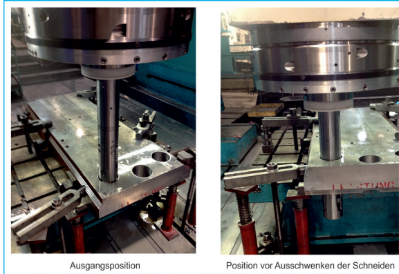
Bild 3: Einsatz des Werkzeuges auf einem Groß-BAZ
