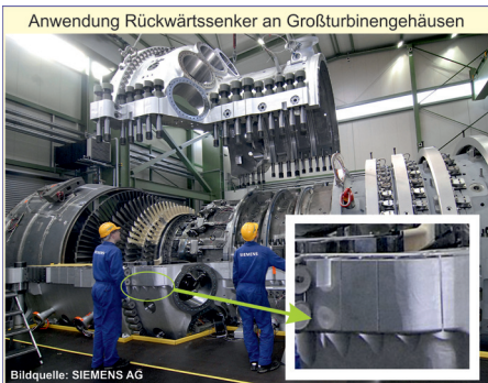
Bild 1: Gasturbine mit zu fertigenden Senkungen (Quelle: Siemens AG)
