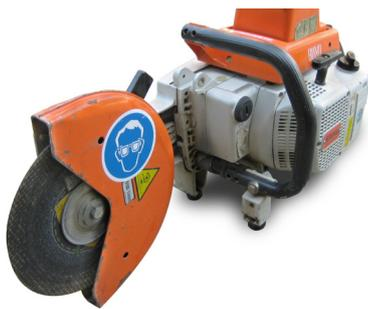
Bild 1: Handgeführte Trennschleifer
