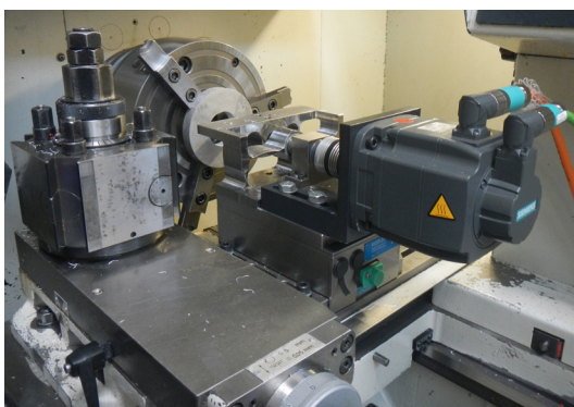
Bild 1: Bearbeitungsmodul zum Drehen mit überlagerter oszillierender Bewegung, eingesetzt zum Herstellen einer strukturierten Innenkontur (Bohrung)
