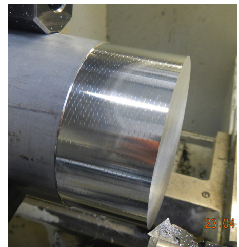
Bild 3: Bearbeitungsbeispiel einer strukturierten Zylindermantelfläche aus Aluminium
