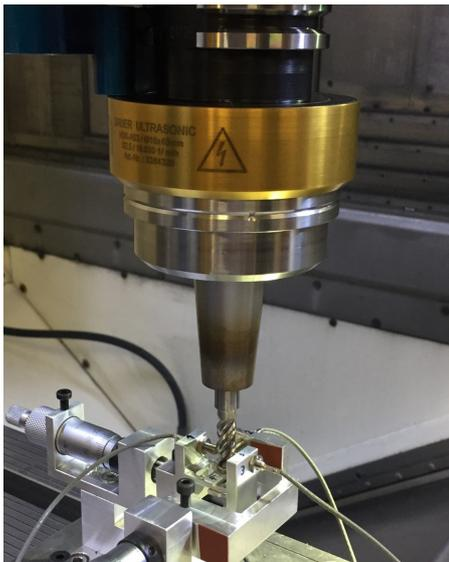
Bild 1: Charakterisierung des Werkzeug-schwingverhaltens
