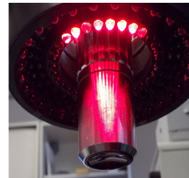
Bild 1: Multi-Ringbeleuchtung mit Bildaufnahmeoptik des realisierten Demonstrators
