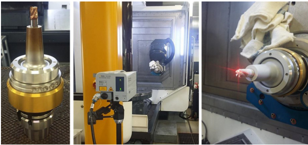
Bild 1: Versuchsaufbau für die Ermittlung der Ultraschallparameter
