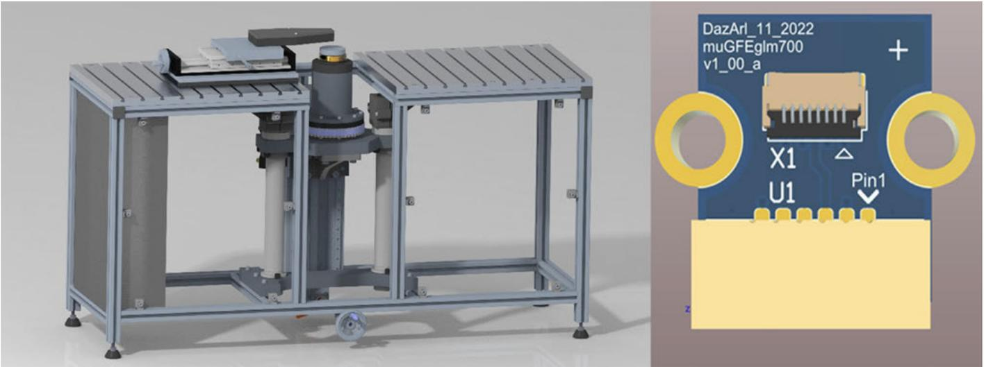
Prüfstand (links) und GMR-Sensormodul (rechts)
