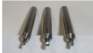
Versuchsfräser mit verschiedenen Makrogeometrien
