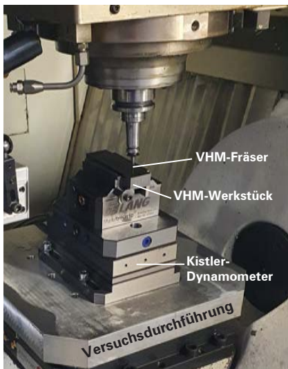
Versuchsfräser mit verschiedenen Makrogeometrien
