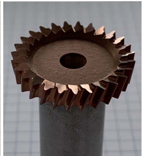
Entwicklung von Bearbeitungstechnologien und neuen Beschichtungen für Wälzschälwerkzeuge
