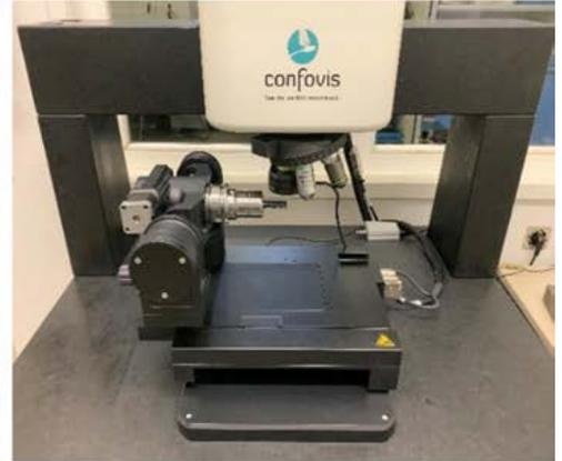
*Konzept zur maschinennahen Werkzeugmessung mittels optischem Messsystem*
